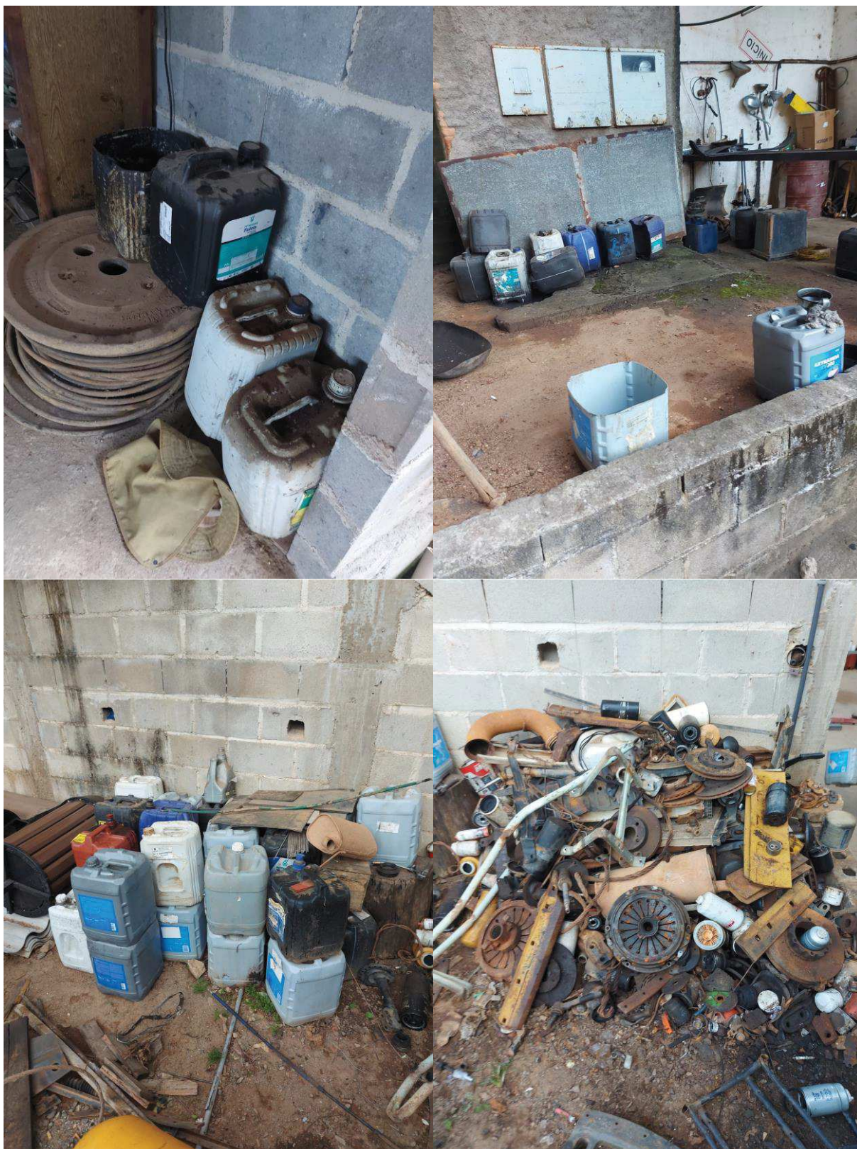
FIGURA 110 – Problemas identificados no armazenamento temporário dos óleos lubrificantes usados
